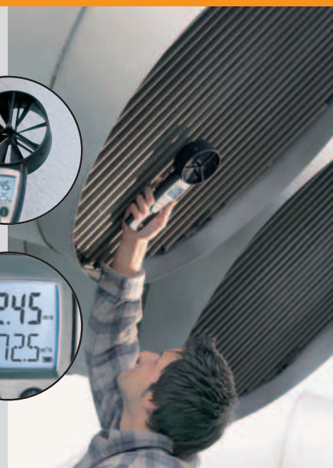
Medición del caudal en un conducto de salida con una sonda molinete de Ø 100 mm
