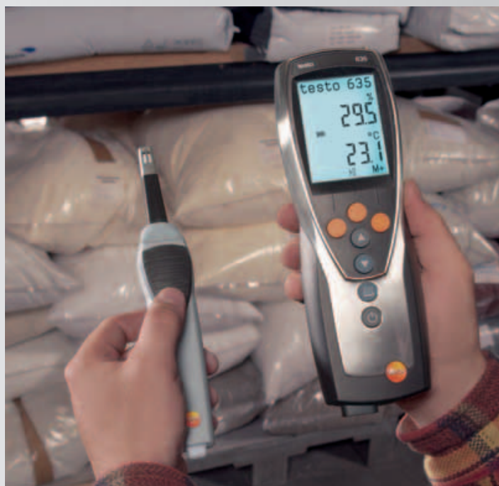
Medición sin cables de la temperatura y la humedad en un almacén, con empuñadura por radio y sonda acoplable de humedad
