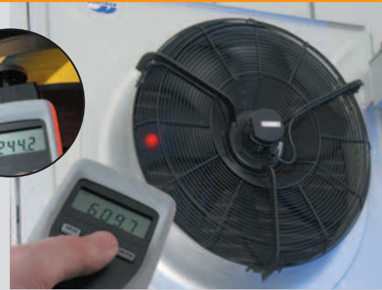
testo 465 y testo 470, medición sin contacto (óptica) de rpm en partes rotativas
