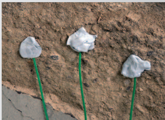
Medición de la temperatura superficial mediante tres sensores termopar de rápida acción
