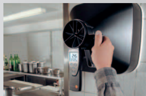
Control del aire de salida en un extractor de pared
