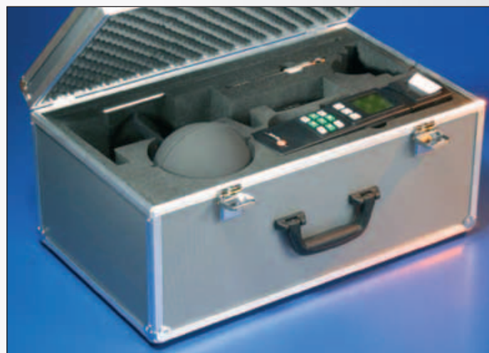
Maleta WBGT para valorar los lugares de trabajo
