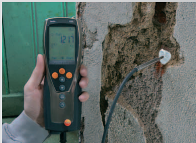
Determinación de la humedad en paredes basada en el equilibrio de humedad en el ambiente
