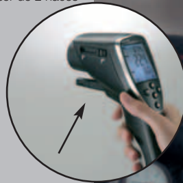
testo 845 con módulo adicional de humedad para medir la humedad ambiente y determinar la diferencia del punto de rocío
