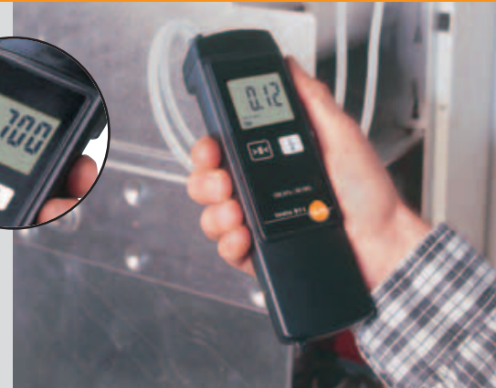
testo 511, medición de la presión diferencial en filtros, por ejemplo
