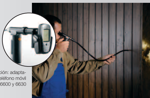
Comprobación en aislamientos mediante la estabilidad del tubo Decabon
