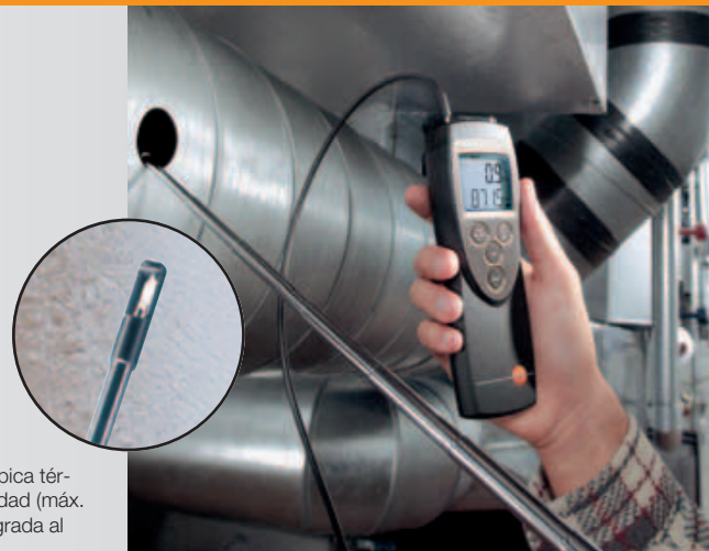
testo 425, p.ej. para controlar el caudal del aire de salida
