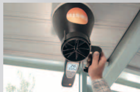
Control del aire de entrada en una boca circular
